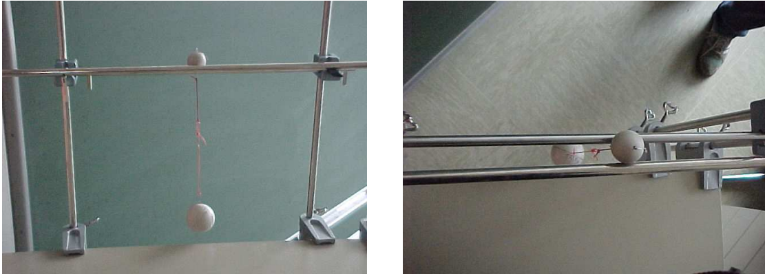
Abbildung 2.5: Versuchsaufbau Rollpendel (links: von vorne, rechts: von oben)
